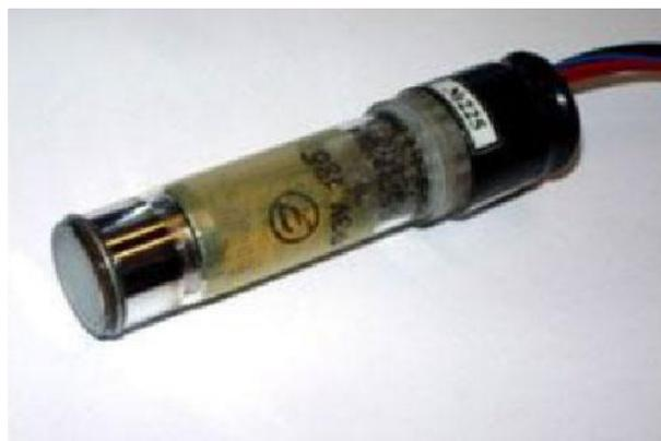
Конструктивное оформление: ФЭУ-186 изготавливается в стеклянном баллоне с торцевым оптическим входом. Входное окно выполнено из боросиликатного увиолевого стекла. В комплект поставки может входить колодка с делителем напряжения.
