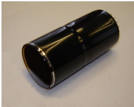
Конструктивное оформление: ФЭУ-176 изготовлен в стеклянном баллоне с торцевым оптическим входом и жесткими выводами. Входное окно выполнено из боросиликатного стекла C50-3 или C52-2.
